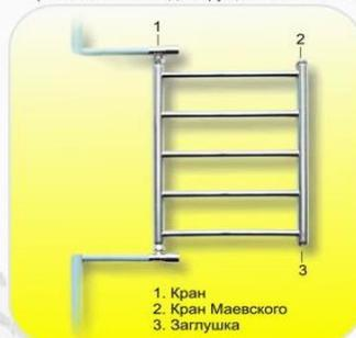
2. Параллельное подключение ГВС
