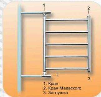
3. Параллельное подключение ГВС
